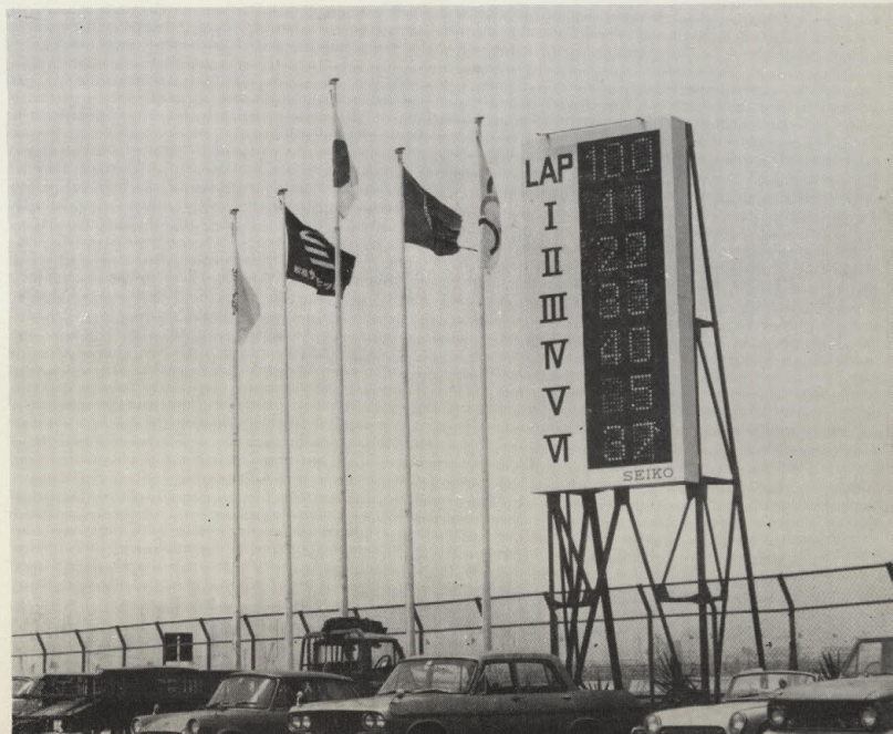
船橋サーキットに設置されている自動車レース用大型電光時計
