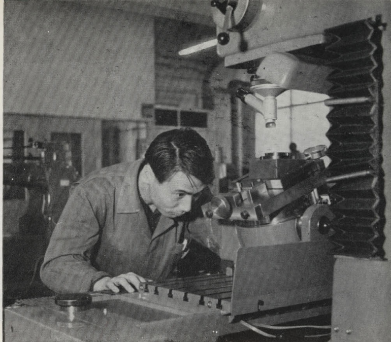
治具ボーラーによる 型の精密加工
